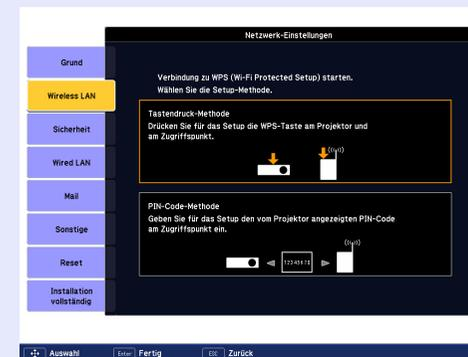
Wenn Sie zum Herstellen der Verbindung die Tastendruck-Methode wählen, gehen Sie wie folgt vor. Gehen Sie zu "Verbindungsherstellung mithilfe der PIN-Code-Methode", wenn Sie zum Herstellen der Verbindung die "PIN-Code-Methode" verwenden möchten.
