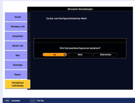
Dies schließt die Einrichtung der Verbindung zwischen dem Projektor und dem Zugriffspunkt ab. Drücken Sie die [Menu]-Taste, um das Konfigurationsmenü zu schließen.
