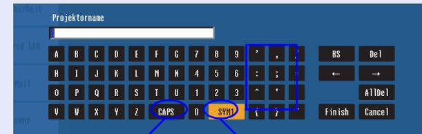
Jedes Mal wenn diese Taste gedrückt wird, wird zwischen Groß- und Kleinbuchstaben gewechselt und die Wahl festgestellt.
