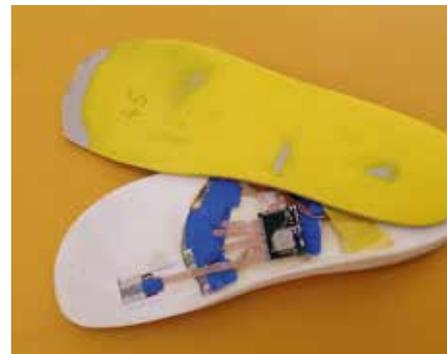
Sensor-Sohle mit integrierter Elektronik
