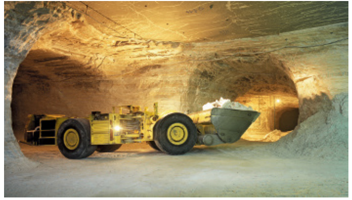
Mit Baggern wird das gesprengte Salz unter Tage abgefahren. Bis zu 17 Tonnen Rohsalz kann dieser Lader auf einmal transportieren.
