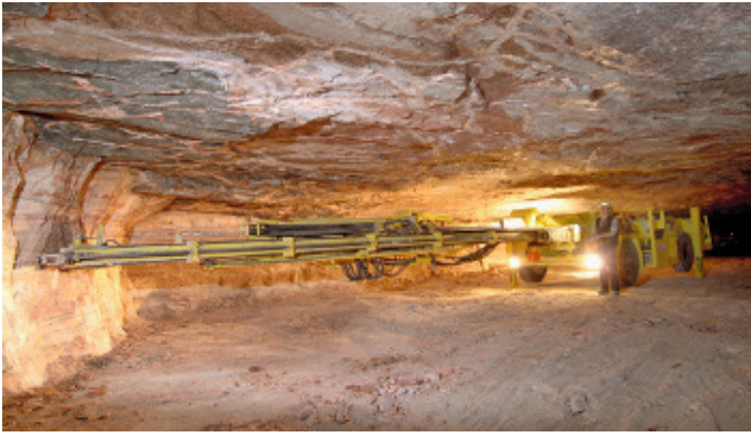
Computergesteuerte Bohrwagen treiben mit höchster Präzision Löcher in das Gestein, die anschließend mit Sprengstoff befüllt werden.
