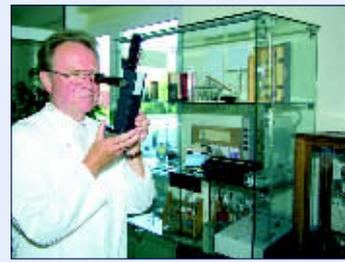
Professor Gerd Lutze bei der Handhabung des Universal-Kolorimeters nach Autenrieth mit Keilküvette für die Eisenbestimmung
