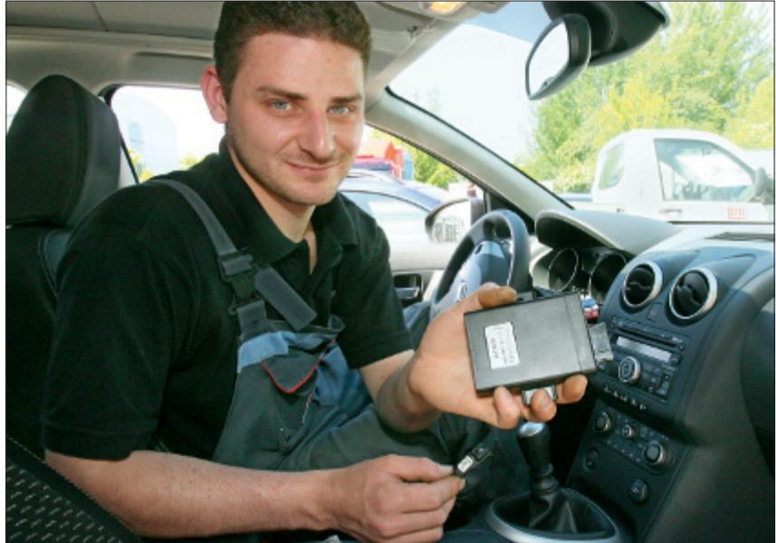
*Klein, schwarz und nach der Montage im Auto nicht zu sehen – das ist die Telematikeinheit des CoPiloten. In der rechten Hand hält Systemtechniker Alexander Degen den Crash-Sensor, der beim Unfall die Beschleunigungskräfte misst. Als erstes Versicherungsunternehmen in Deutschland bietet die ÖSA dieses Sicherheitssystem an. (Foto: Viktoria Kühne)*
